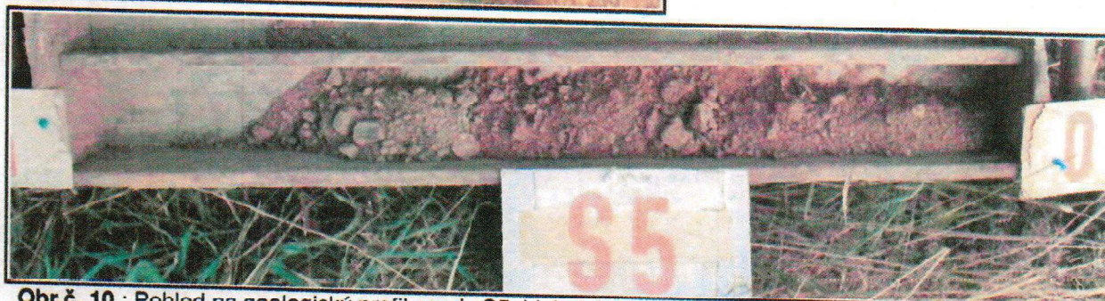
Obr.č. 10 : Pohled na geologický profil sondy S5, hluboké 0,8 m. Svrchní část profilu tvoří prachovitá hlína, velmi pevná, nasedající v hloubce 0,7 m na mírně zvětralou břidlici, pevnostní třídy R5. Níže nehloubitelné vibračním zarážením.
