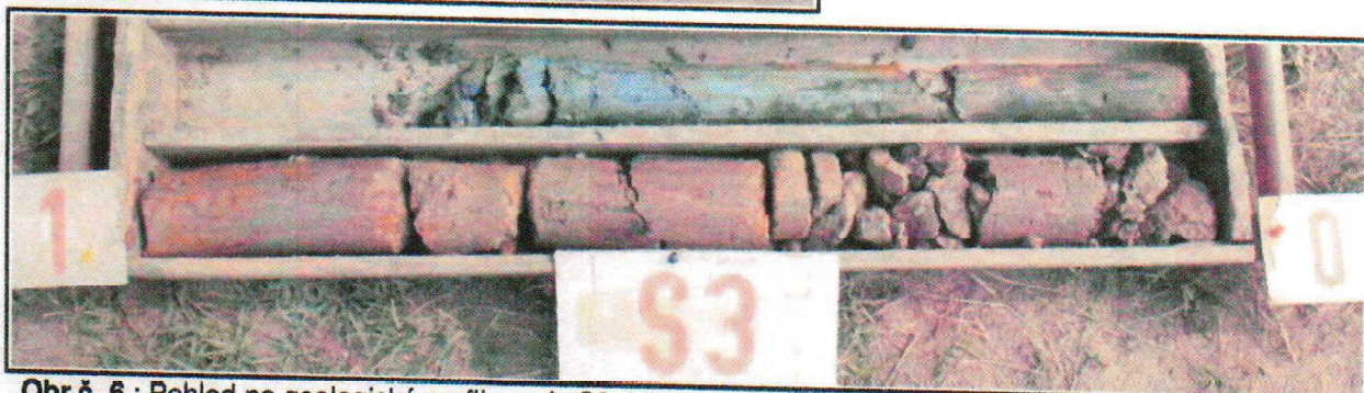
Obr.č. 6 : Pohled na geologický profil sondy S3, hluboké 1,7 m. Svrchní část profilu tvoří prachovitá hlína, velmi pevná, nasedající v hloubce 0,7 m na jílu hlinitý, tuhý až pevný. Od úrovně 1,4 m zastížen jílem písčitém, pevným, s křemennou drtí a štěrčkem do vel. 5 mm. Podzemní voda v sondě nezastížena.
